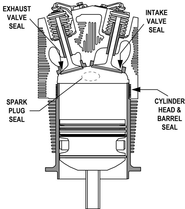
**FIGURE 20-8. STATIC SEAL**
