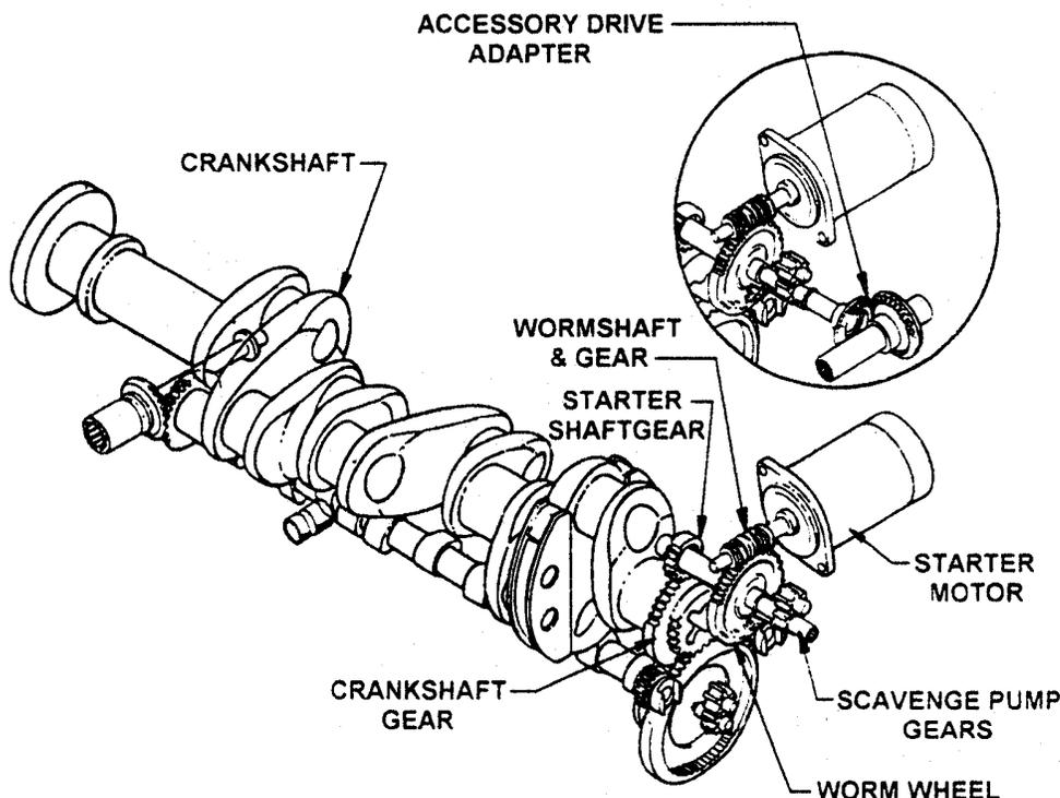
FIGURE 17-1. STARTER AND STARTER ADAPTER DESCRIPTION
