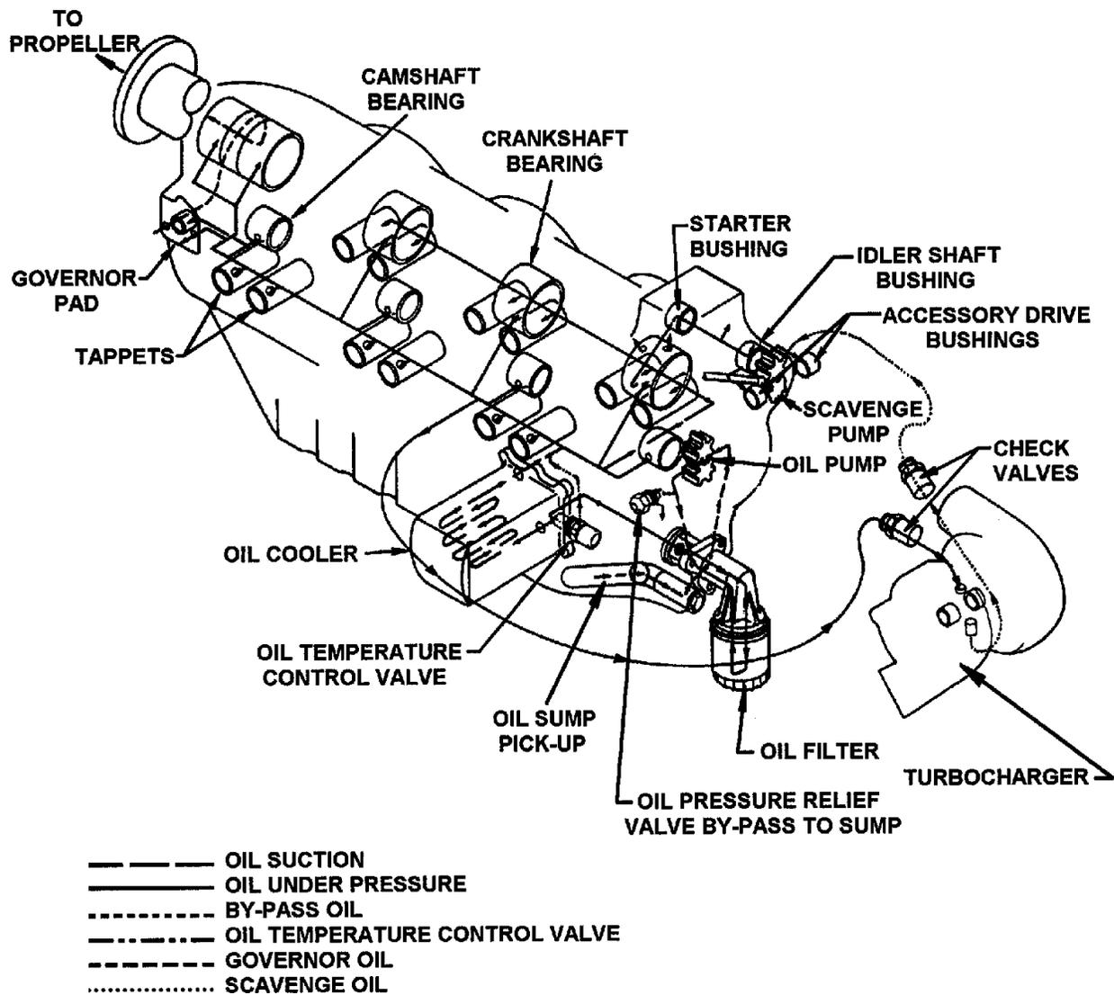
FIGURE 19-1 LUBRICATION SYSTEM SCHEMATIC
