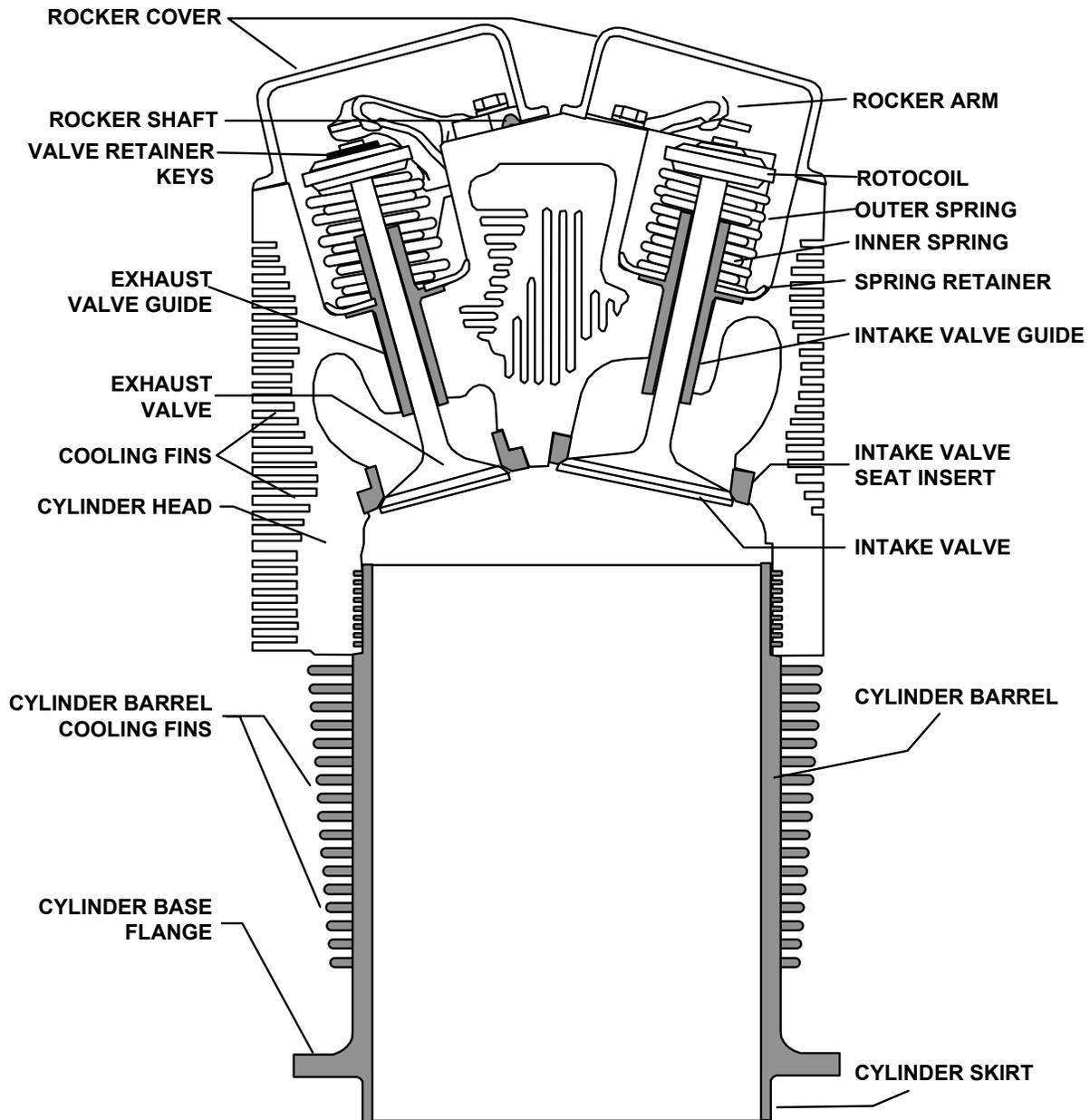
FIGURE 20-3. CYLINDER ASSEMBLY DESCRIPTION
