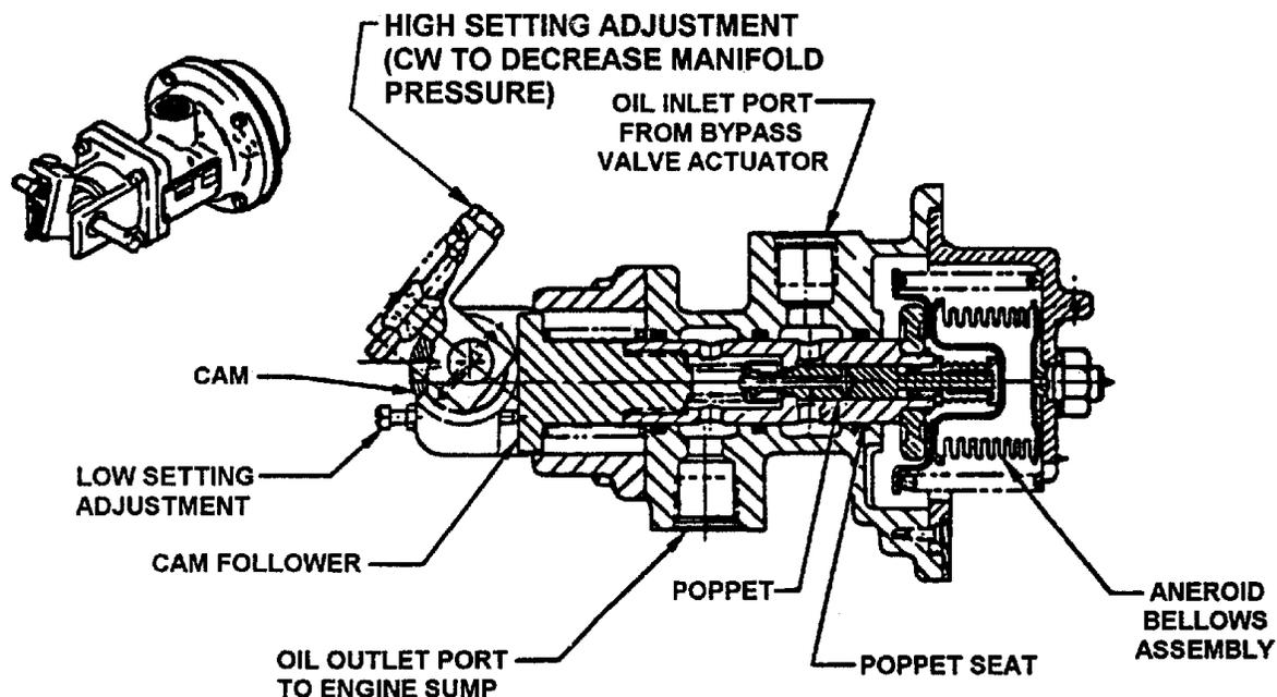
FIGURE 11-5. VARIABLE ABSOLOLUTE PRESSURE CONTROLLER
