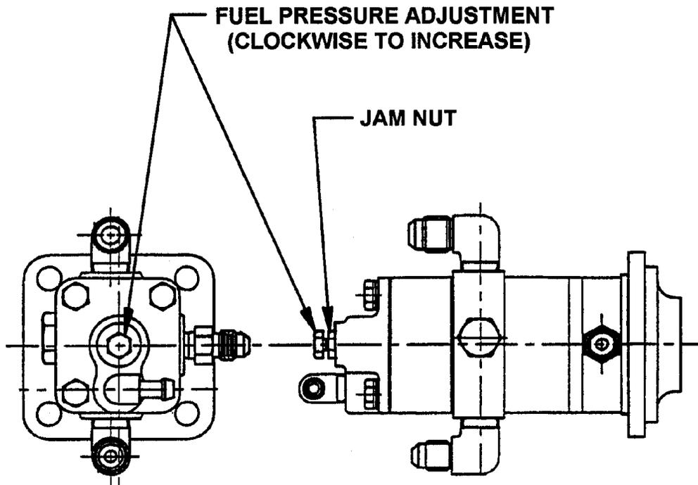
FIGURE 23-2. FUEL PUMP ADJUSTMENT
