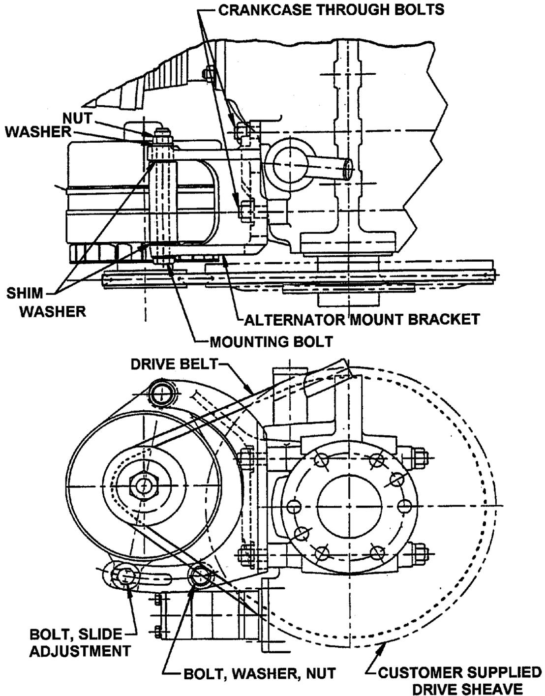
FIGURE 16-1. BELT DRIVEN ALTERNATOR
