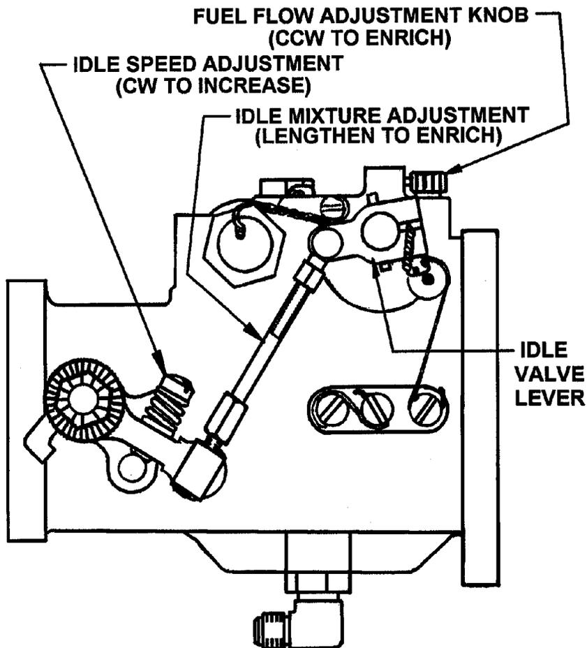
**FIGURE 23-3. FUEL MIXTURE ADJUSTMENT**
