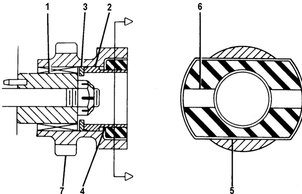
FIGURE 12-1. MAGNETO ACCESSORY DRIVE ADAPTER
