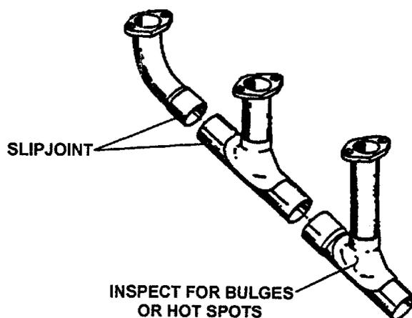
FIGURE 11-6. SLIP JOINT ASSEMBLY
