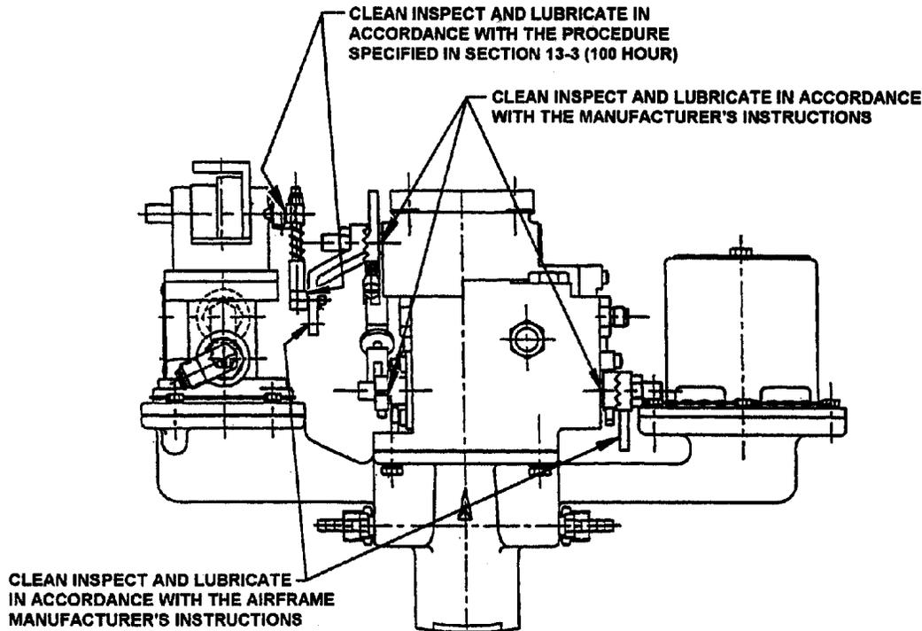
**FIGURE 13-5. GENERAL CONTROL LINKAGE LUBRICATION POINTS**
