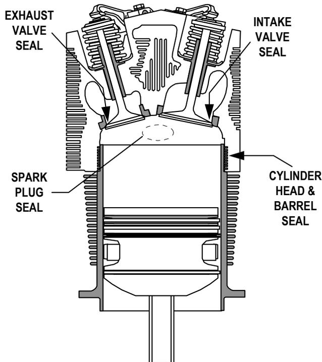
**FIGURE 20-8. STATIC SEAL**
