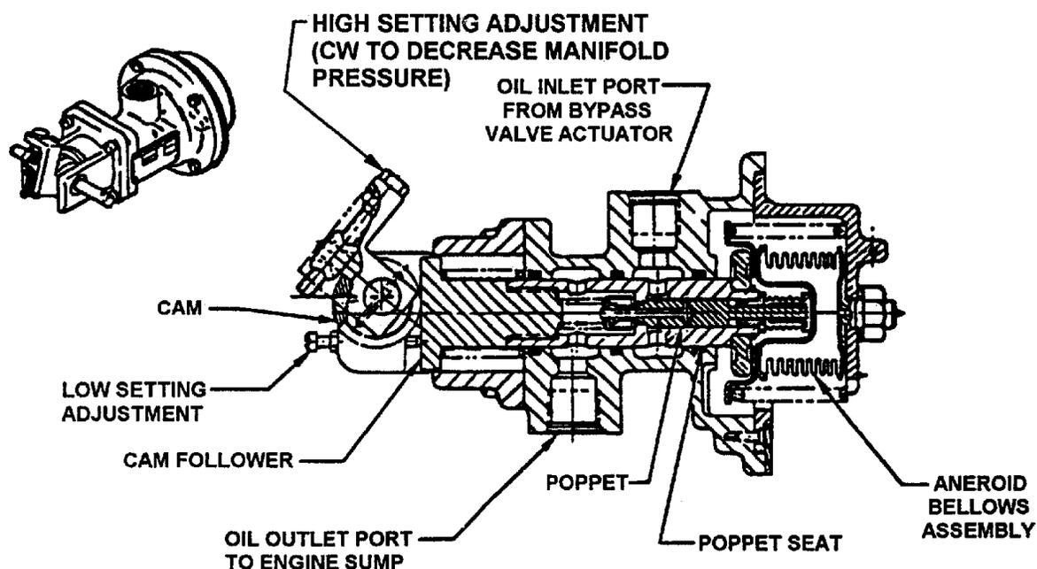
FIGURE 11-5. VARIABLE ABSOLOLUTE PRESSURE CONTROLLER
