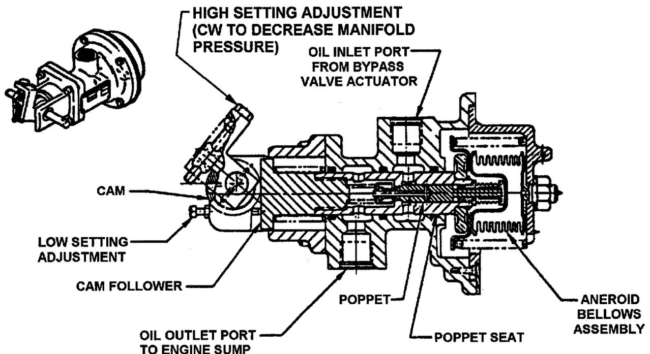
FIGURE 23-4. CONTROLLER ADJUSTMENT
