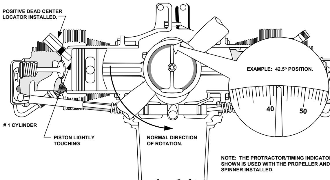
**FIGURE 12-5. TIMING POSITION STEP 3**
