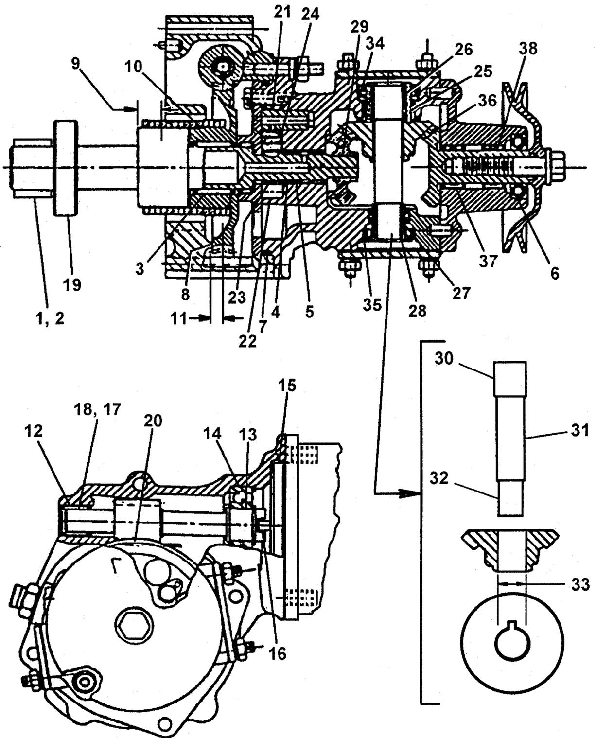
FIGURE 17-4. STARTER ADAPTER FITS & LIMITS
