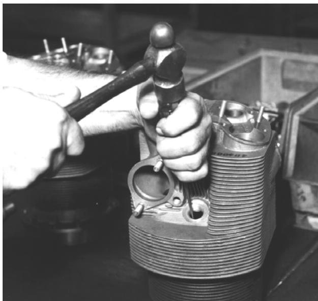
**FIGURE 16-7. PRYING SPARK PLUG HELICAL COIL AWAY FROM CYLINDER**
