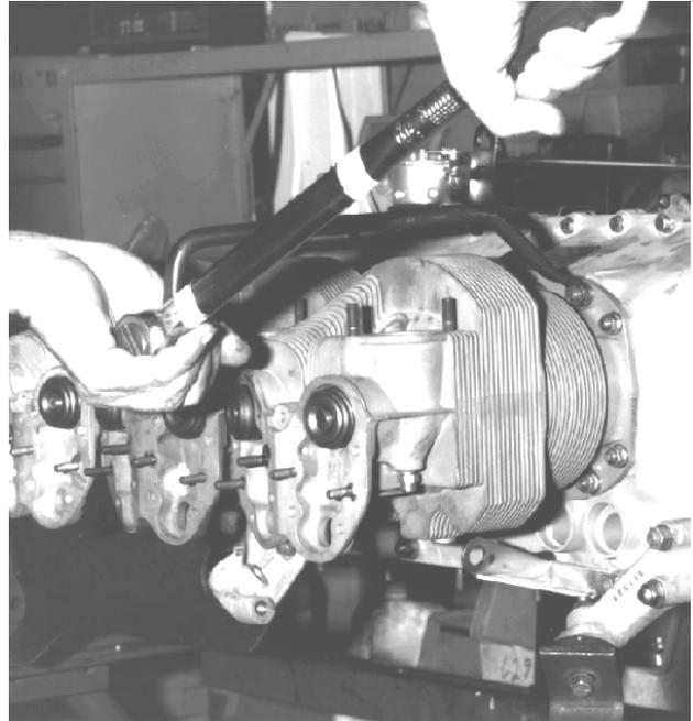
**FIGURE 19-8. TORQUING CYLINDER BASE NUT**
