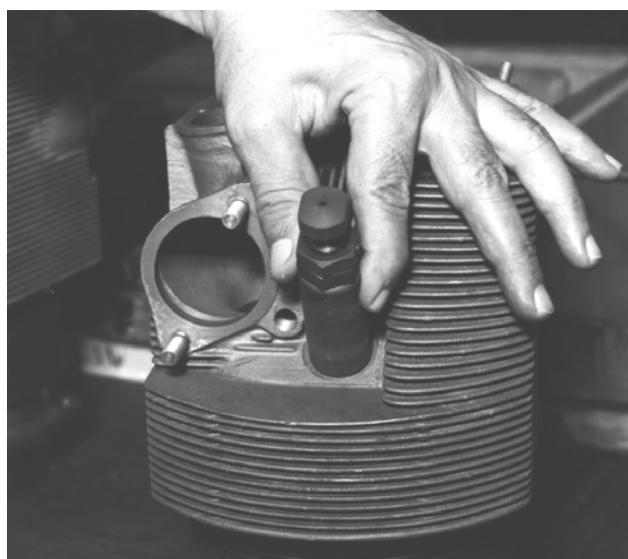
**FIGURE 16-10. EXPANDING SPARK PLUG HOLE HELICAL INSERT**
