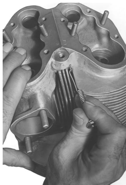
**FIGURE 16-18. SECURING BAFFLE**
