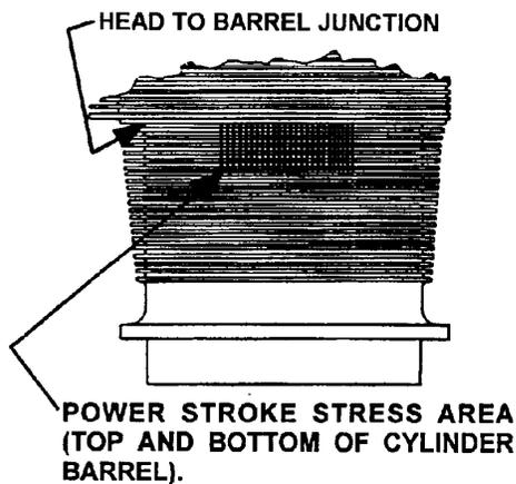
**CYLINDER BARREL FIN TIP REPAIR**
