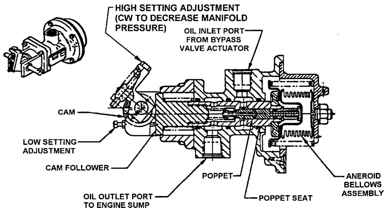
**FIGURE 20-4. CONTROLLER ADJUSTMENT**
