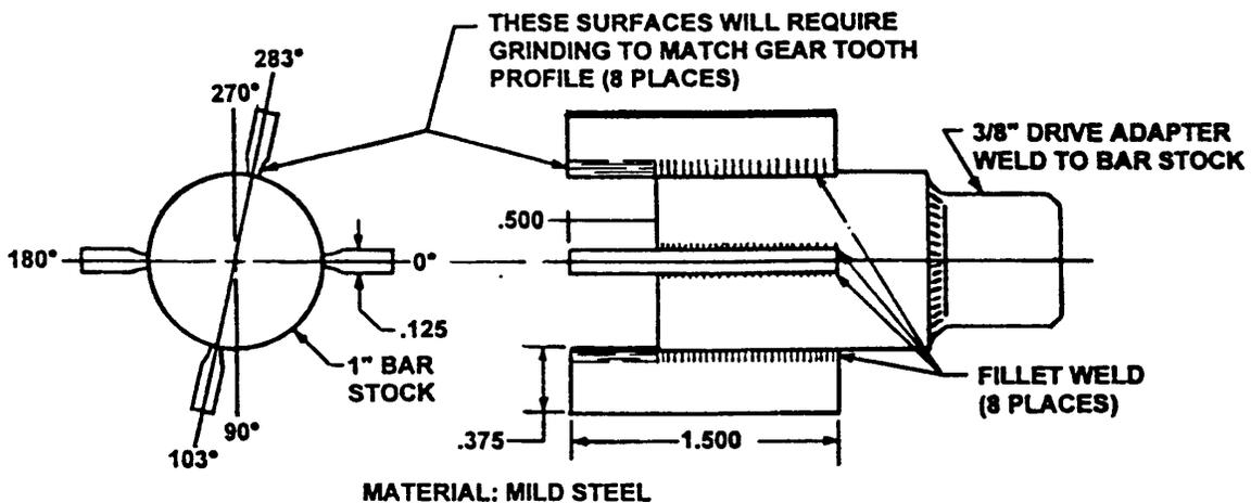
**FIGURE 12-2. SLIPPAGE INSPECTION TOOL**
