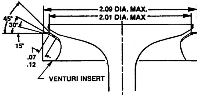
**INTAKE SEAT GRINDING**
