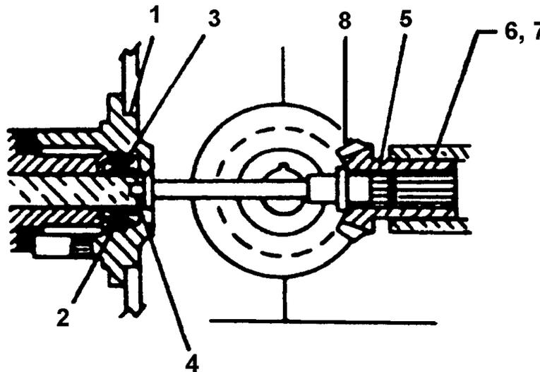
**FIGURE 9-5. FUEL PUMP DRIVE COUPLING FITS AND LIMITS**
