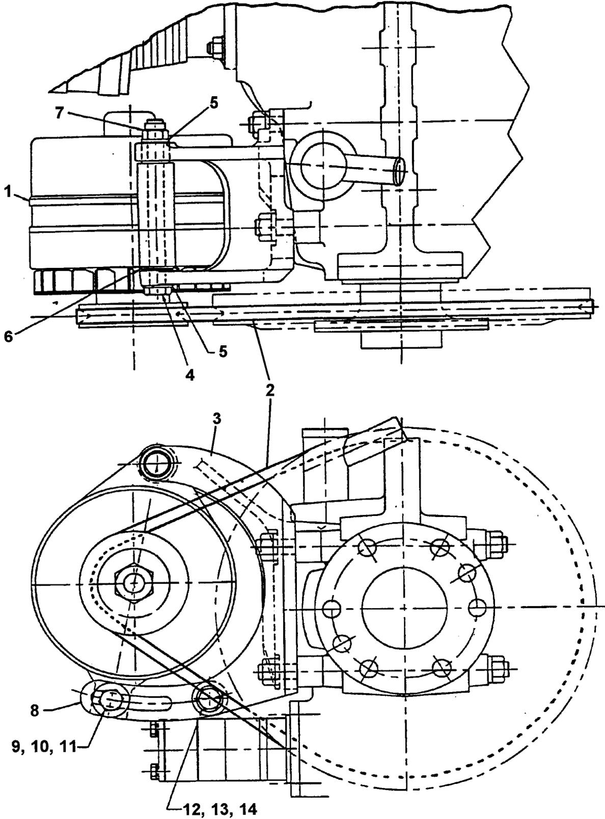
FIGURE 6-6. BELT DRIVEN ALTERNATOR ASSEMBLY
