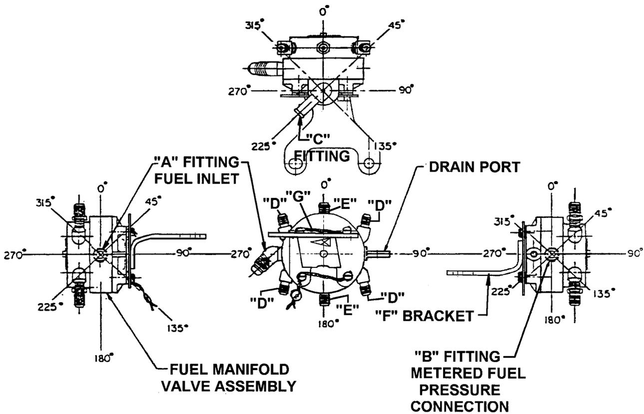
FIGURE 9-1. FUEL PUMP FITTING LOCATIONS
