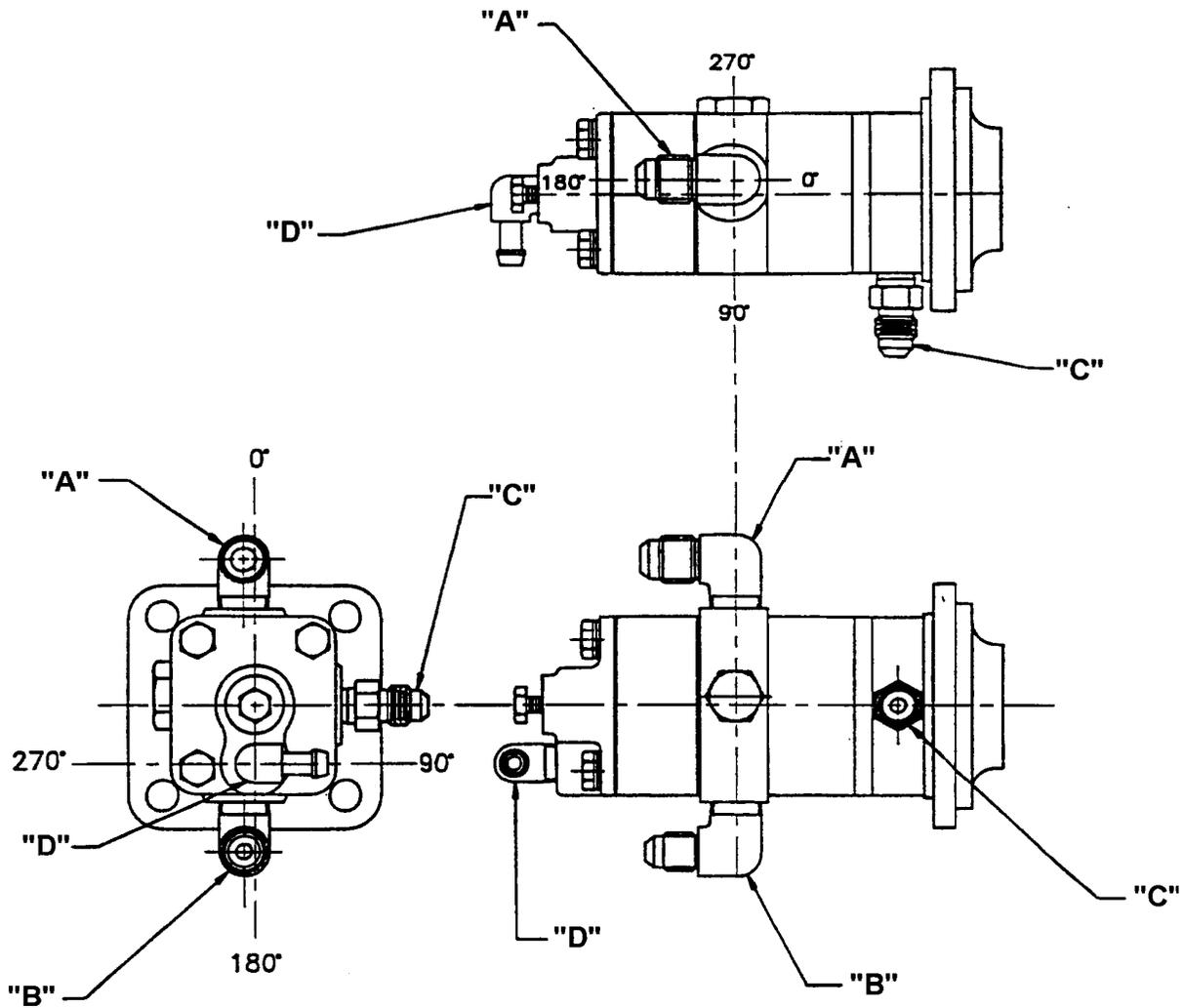
**FIGURE 9-2. FUEL PUMP FITTING LOCATIONS**
