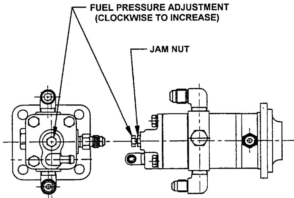
**FIGURE 20-2. FUEL PUMP ADJUSTMENT**
