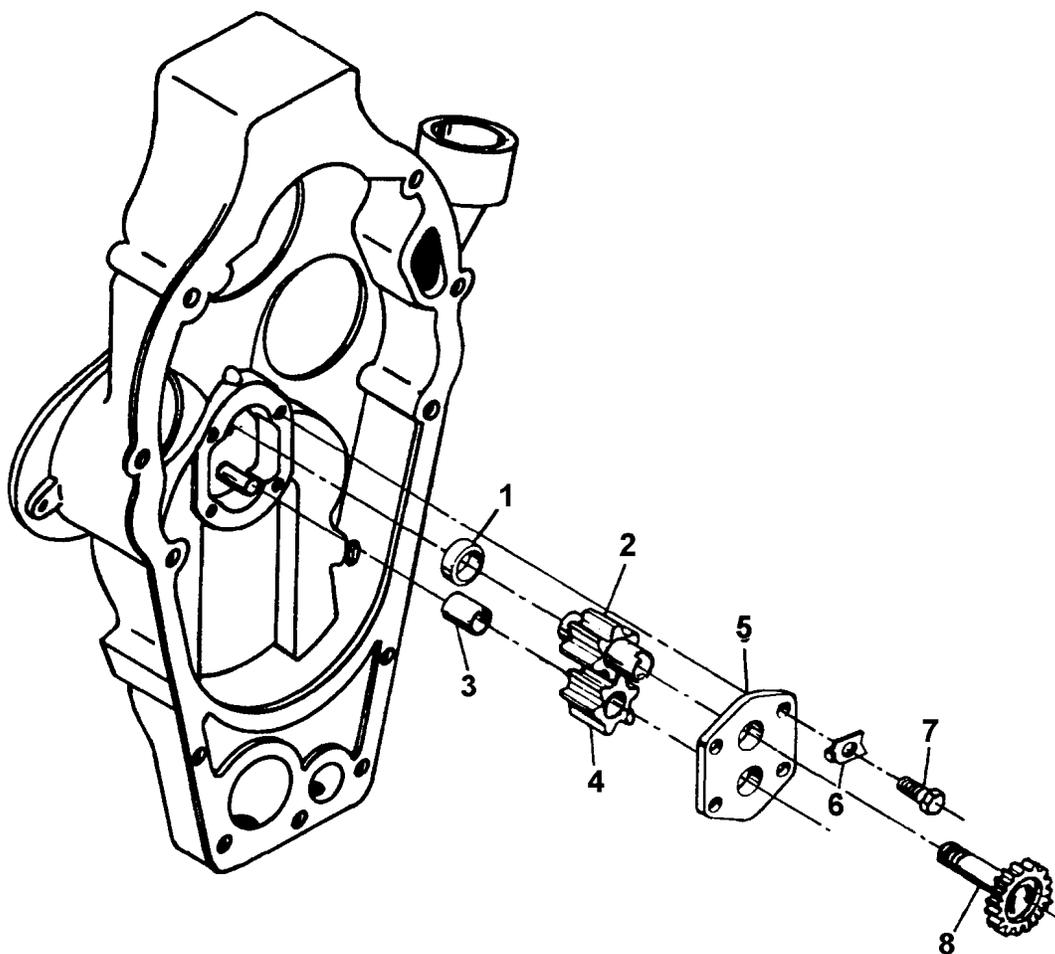
FIGURE 6-11. OIL PUMP ASSEMBLY
